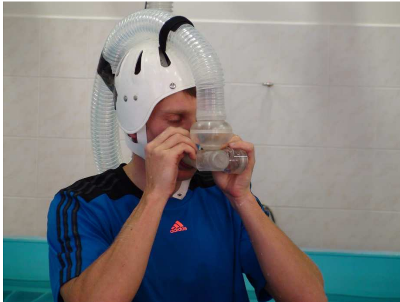
Obrázek č. 3: Helma s připevněnou dechovou hadicí a přístrojem Ergo – oxyscreen.
